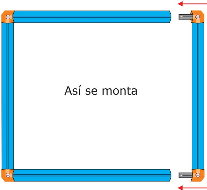
Con los cuatro conectores de 2 salidas y con 4 tubos de un metro podemos formar un  $m^2$ .
